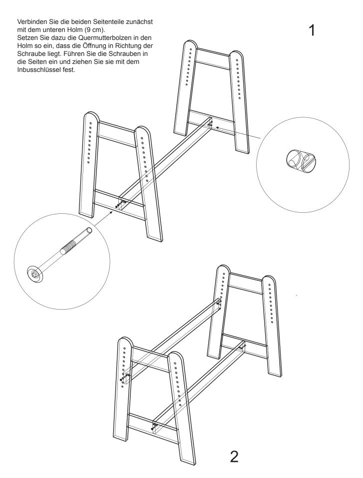
Verfahren Sie mit dem oberen Holm in gleicher Weise.
